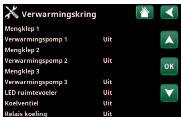
Menu: "Installateur/Service/Functietest/Verwarmingskring".
