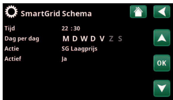
De SmartGrid functie "SG Laagprijs" is gepland op weekdays van 22:30-06:00. Ga naar het menu door "SmartGrid Schema" te selecteren in het menu "Installateur/Instellingen".
