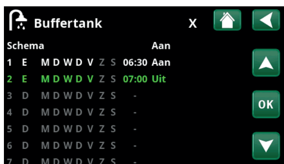
In het voorbeeld wordt elke week het opwarmen van de buffertank geactiveerd - maandag t/m vrijdag tussen 06:30 en 07:00 uur.
