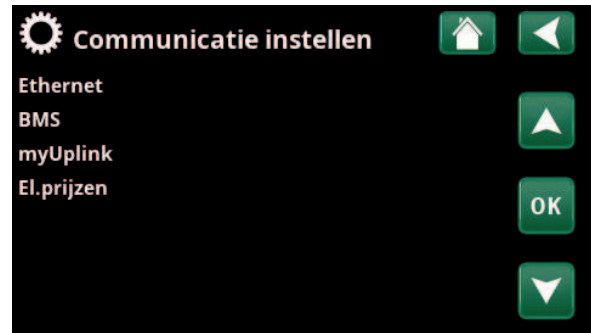
Menu: "Installateur/Instellingen/Communicatie".
