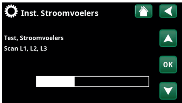
Menu: "Geavanceerd/Instellingen/Stroomvoelers /Auto config. stroomvoeler".
