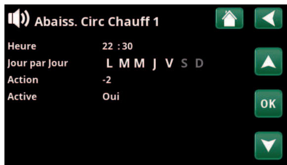
Réglage de la réduction nocturne (-2 °C), nuits en semaine.
