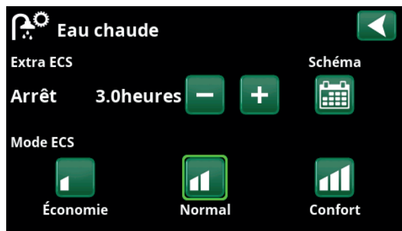
Paramétrage de «Extra ECS» dans le menu «ECS».
