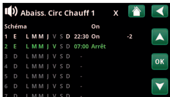
Le schéma a été paramétré pour que «Réduct. Nuit» soit activé en semaine entre 22h30 et 7h00, à l'exception des nuits de vendredi à samedi et de samedi à dimanche (aucun abaissement ne se produit).
