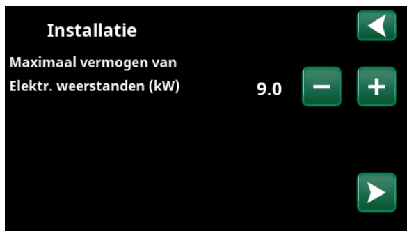
5. Selecteer het maximale vermogen van de elektr. weerstand met de knoppen "+" en "-". Bevestig met de "pijl naar rechts". Meer informatie over instellingen staat in het hoofdstuk "Installateur/Instellingen/Elekt. weerstand".
